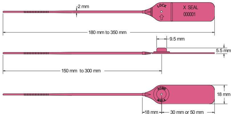
El precinto X es un sello hermético de plástico suave y versátil fabricado con material de polipropileno. El diseño presenta una tecnología de acumulación de calor enrollada para asegurar el inserto de resorte de metal al cuerpo, lo que proporciona una clara evidencia de manipulación en caso de apertura o corte forzado. Este sello es ideal para la mayoría de las aplicaciones, especialmente donde hay pequeñas aberturas de sellado.
