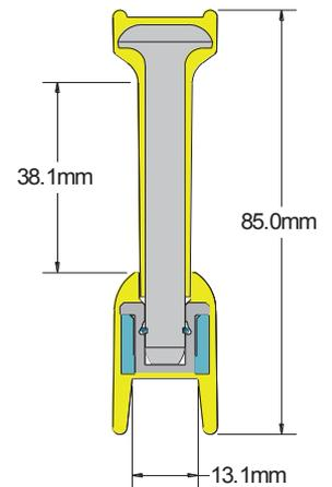
Este sello de perno es de alta seguridad que cumple con la norma ISO 17712:2013 (E), diseñado para envíos de carga de contenedores ISO de alto valor. El perno recubierto de plástico y el casquillo de bloqueo están marcados con láser con números secuenciales idénticos para mayor seguridad. Cuando está bloqueado, el perno gira libremente para confirmar la integridad del sello.
