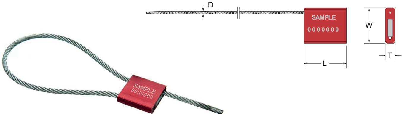
El precinto de cable CS1 está disponible en varias longitudes y diámetros de cable para satisfacer todos los requisitos. El cuerpo de la cerradura está fabricado de aluminio fundido de presión y el cable de acero galvanizado no preformado. El cable tiene una punta soldada para facilitar el bloqueo y, si se corta, se desenreda haciendo imposible volver a bloquear el sello nuevamente sin mostrar signos evidentes de manipulación. El precinto de cable requiere cuchillas para su extracción.
